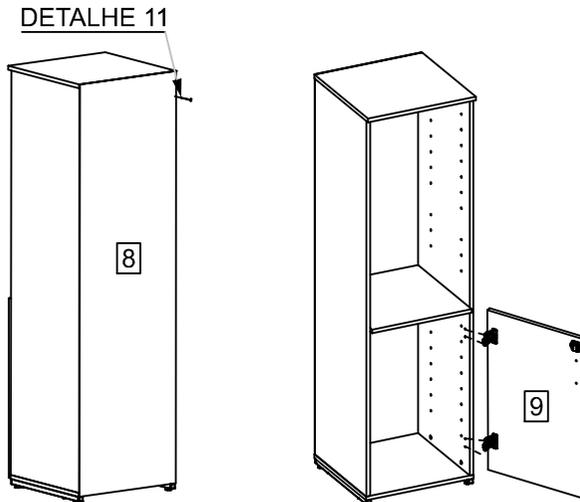
Na sequência fixar o Fundo (8) com a utilização de pregos (H) nas Laterais (1) e (3) e Prateleira Fixa (2). Após a fixação do Fundo, fazer a colocação da Porta, peça (09), utilizando o parafuso item (L), Conforme (Detalhe 08) Obs. A porta deve ser ajustadas após a instalação.
